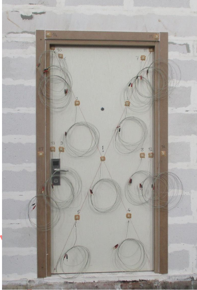
Fotoğraf C1: Test numunesinin aleve maruz kalmayan yüzeyinin test öncesi görünümü
