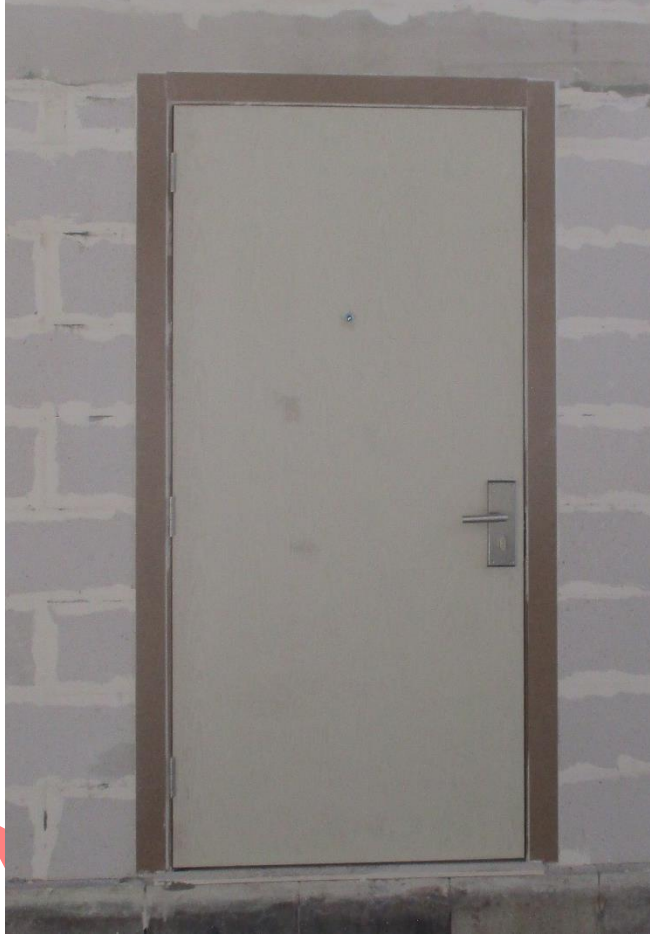
Fotoğraf C2: Test numunesinin aleve maruz kalan yüzeyinin test öncesi görünümü
